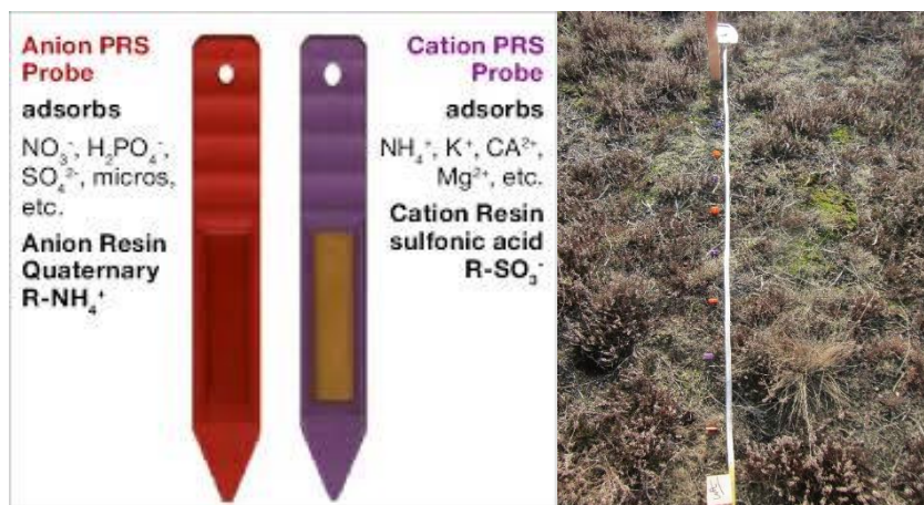
Fig. 3.1 Links: anion en kation PRS Probes (PRSTM, Western Ag Innovations Inc., Saskatoon, Canada). Rechts: overzicht van de geplaatste PRS probes in een proefveld van stuifzandheide.
